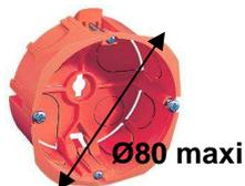
D'une manière générale notre appareillage se monte sur l'ensemble des boîtes d'encastrement 65 ou 67/68mm destinées au montage **d'appareillage à vis**. L'entraxe des vis est standard, il est de 60mm. Plus précisément notre gamme est adaptée aux **boîtes rondes 1 poste** ayant un encombrement maxi de 80mm.
